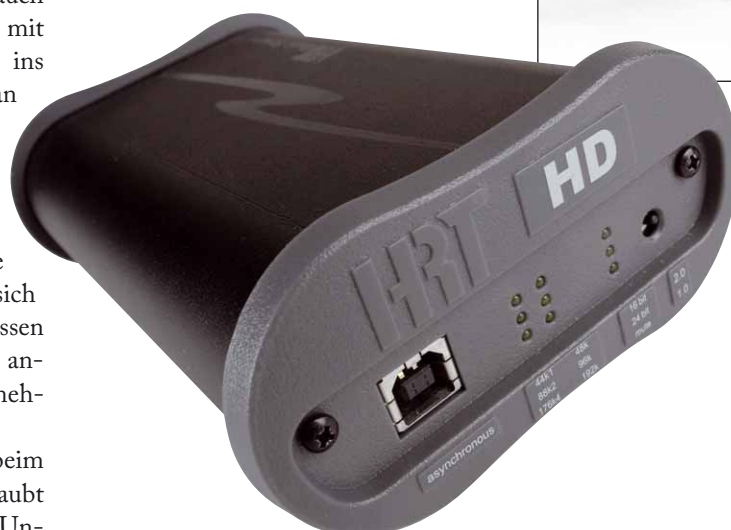
LEDs informieren über Abtastrate und Bittiefe. Per Schalter kann man von USB Class 1 auf Class 2 umstellen
